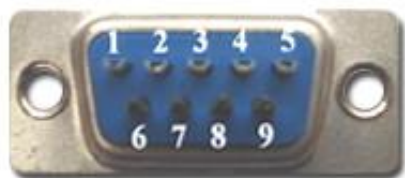
DB9 FÊMEA PARTE TRASEIRA Pontos para solda
