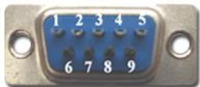
DB9 FÊMEA PARTE TRASEIRA Pontos para solda
